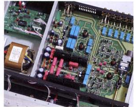
Vincent-Vorstufe: Die Röhren- und Transistorstufen laufen direkt gekoppelt, die roten und blauen Kondensatoren reinigen Speisestrom.
