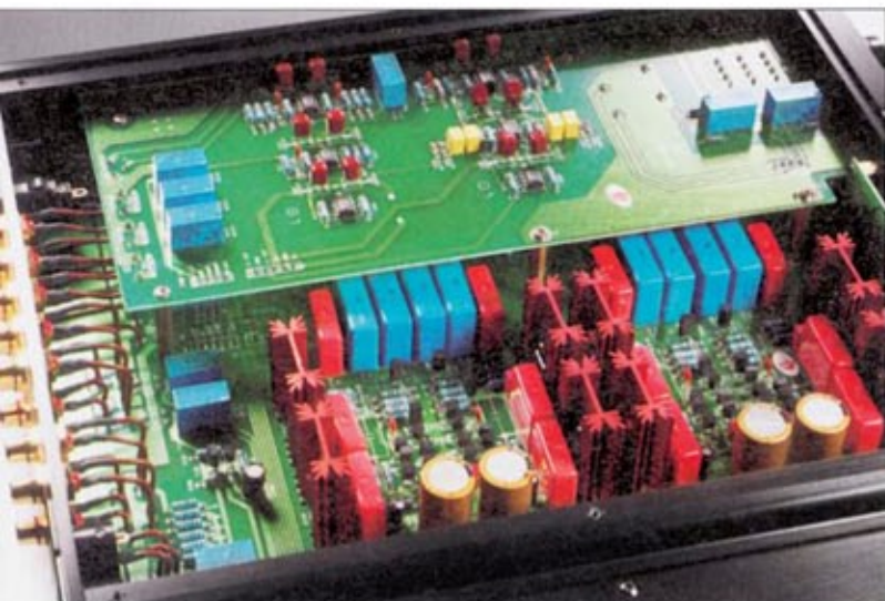
Der Preamp glänzt mit einem vorbildlichen Platinen-Layout. Die Kanäle sind strikt voneinander getrennt. Recht kräftige Kabel führen die Signale von den Ein- und Ausgangsbuchsen zu den Verstärkerstufen.
